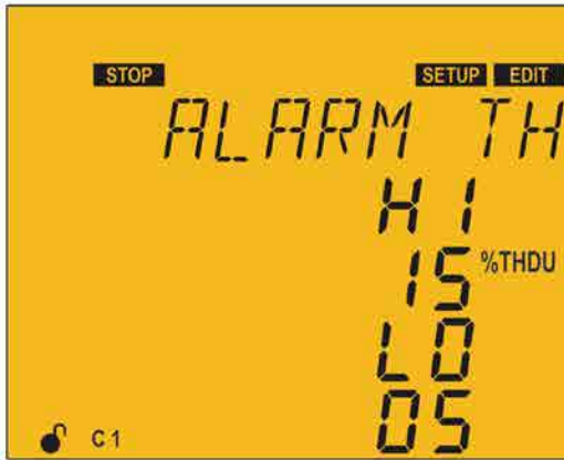
تصویر ۵ - ۲۹ صفحه تنظیم مقادیر آلامر THD ولتاژ
