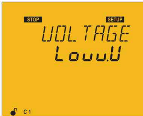
تصویر ۵ - ۱۴ صفحه‌ی تنظیم سطح ولتاژ
